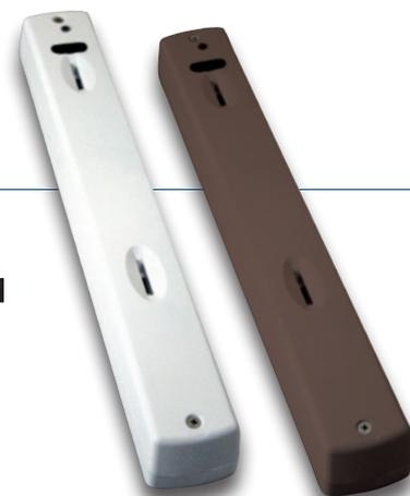
*Il rivelatore è la soluzione ideale per la protezione di porte e finestre, in quanto realizza un vero e proprio effetto tenda grazie alla coppia di rivelatori ad infrarossi passivi. L'installazione avviene al centro della parte superiore dello stipite della porta o della finestra da proteggere, collocato tra l'infisso e la tapparella o persiana.*
