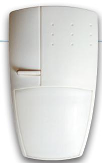
Disponibile in 3 versioni: con lente volumetrica, con lente lineare per corridoi o perimetri interni, con lente a tenda per protezione di pareti. È dotato di uno snodo autobloccante che impedisce gli spostamenti involontari o intenzionali. E' possibile programmare la sensibilità su 2 diversi livelli.
