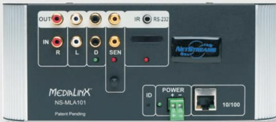
MediaLinx - Audio converter: Convertitore di ingressi ed uscite analogiche su sistema Digilinx IP.N.1 Ingresso stereo analogico con RCA, n.1 Uscita stereo analogica su RCA, n.1 Ingresso e uscita SPDIF digitale su RCA, 1 ingresso \ uscita sorgenti video su RCA, 1 ingresso e uscita sorgenti all'infrarosso, 1 uscita RJ45 su network ethernet, 1 ingresso alimentazione DC 28V, misure 210x86x50mm, peso 0,6 Kg
