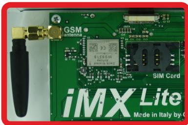
Questo particolare modello è caratterizzato dalla presenza del comunicatore XC-GSM su scheda (built-in). Non è pertanto richiesta l'installazione del XC-GSM, né è possibile, in quanto non presente l'apposito connettore. Per lo stesso motivo, non è possibile l'installazione del comunicatore Pstn XC-TEL. Su questo modello, pertanto, la comunicazione GSM/GPRS è l'unica possibile ed attuabile.
