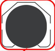
Slot per batteria tampone al litio **CR2032**
